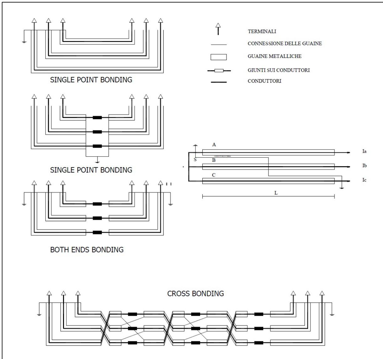
Figura 10 – Schema di connessione delle guaine metalliche
