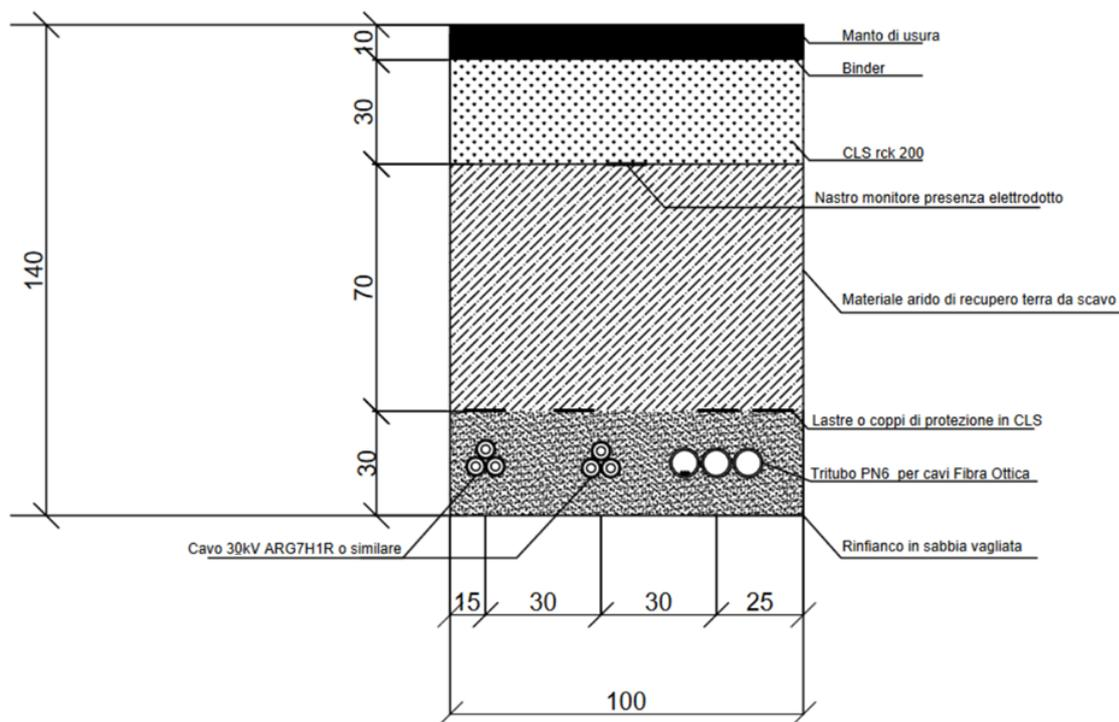
Figura 8 – Sezione tipo su manto stradale
