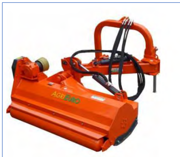
Figura 177: Esempio di trincia con il traslatore destra/sinistra
