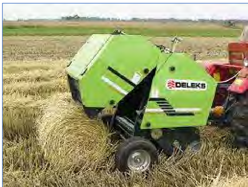
Figura 178: Esempio di mini-rotoimballatrice
