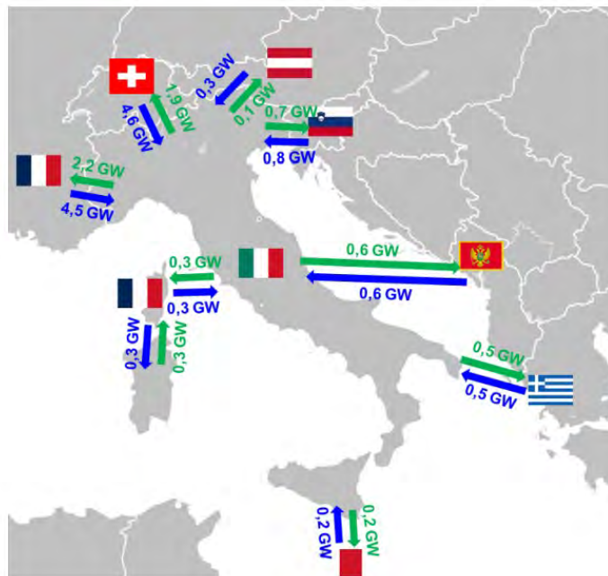
Figura 4 - Capacità di scambio transfrontaliera in import ed export delle interconnessioni esistenti (elaborazione max NTC 2023 e limiti di transito - fonte Terna)
