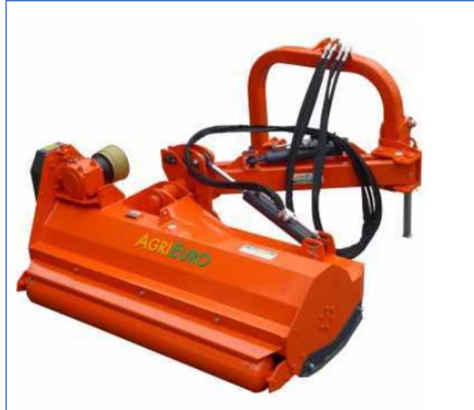
Figura 26: Esempio di trincia con il traslatore destra/sinistra
