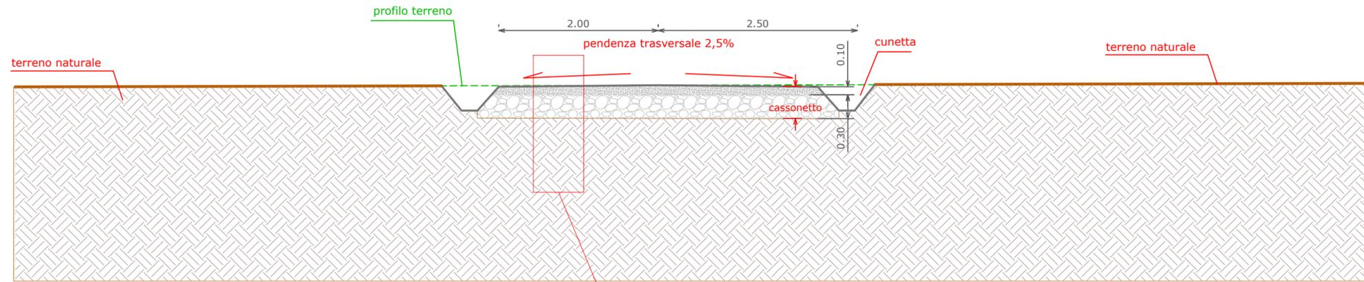
PARTICOLARE SEZIONE STRADALE TIPO - Scala 1:10
