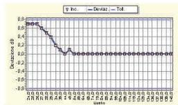
**Linearità di livello comprendente il selettore del campo di misura**
