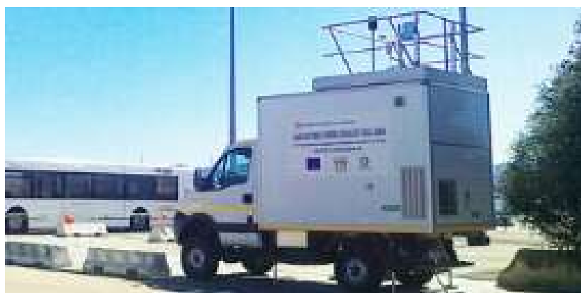
Fig. 6-4: Stazione mobile per il monitoraggio degli inquinanti da traffico veicolare, polveri e meteoclima
