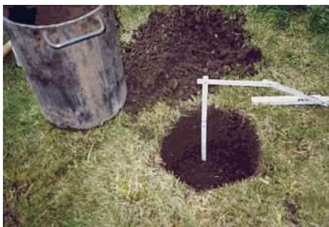
Fig. 7-12: Prova di Permeabilità superficiale
