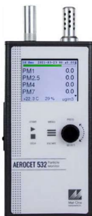
Fig. 6-3: Strumentazione tipo per la misura del particolato in continuo
