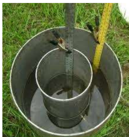
Fig. 7-13: Infiltrometro a doppio anello
