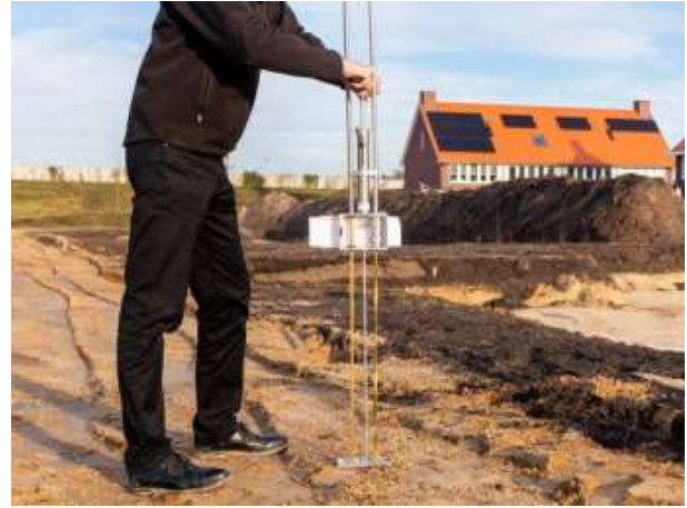
Fig. 7-10: Penetrografo manuale per misure di compattazione del terreno
