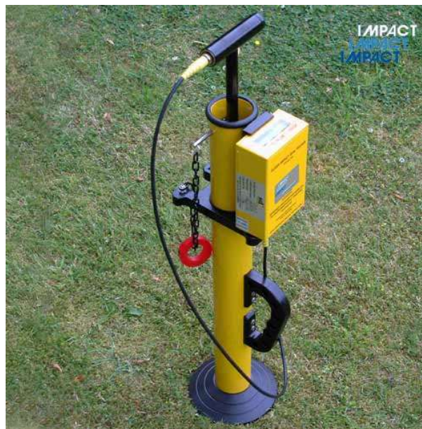
Fig. 7-11: Strumentazione ad impatto per Clegg Test
