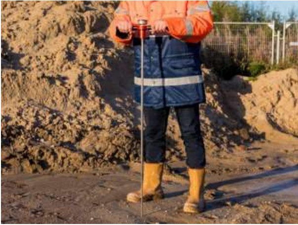
Fig. 7-9: Penetrometro manuale per la misura della densità in situ
