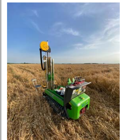
Sondaggio DPSH – P4
