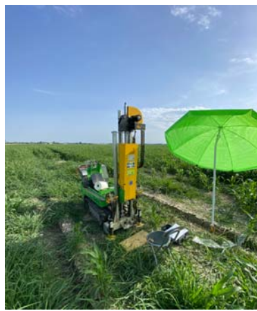
Sondaggio DPSH – P2
