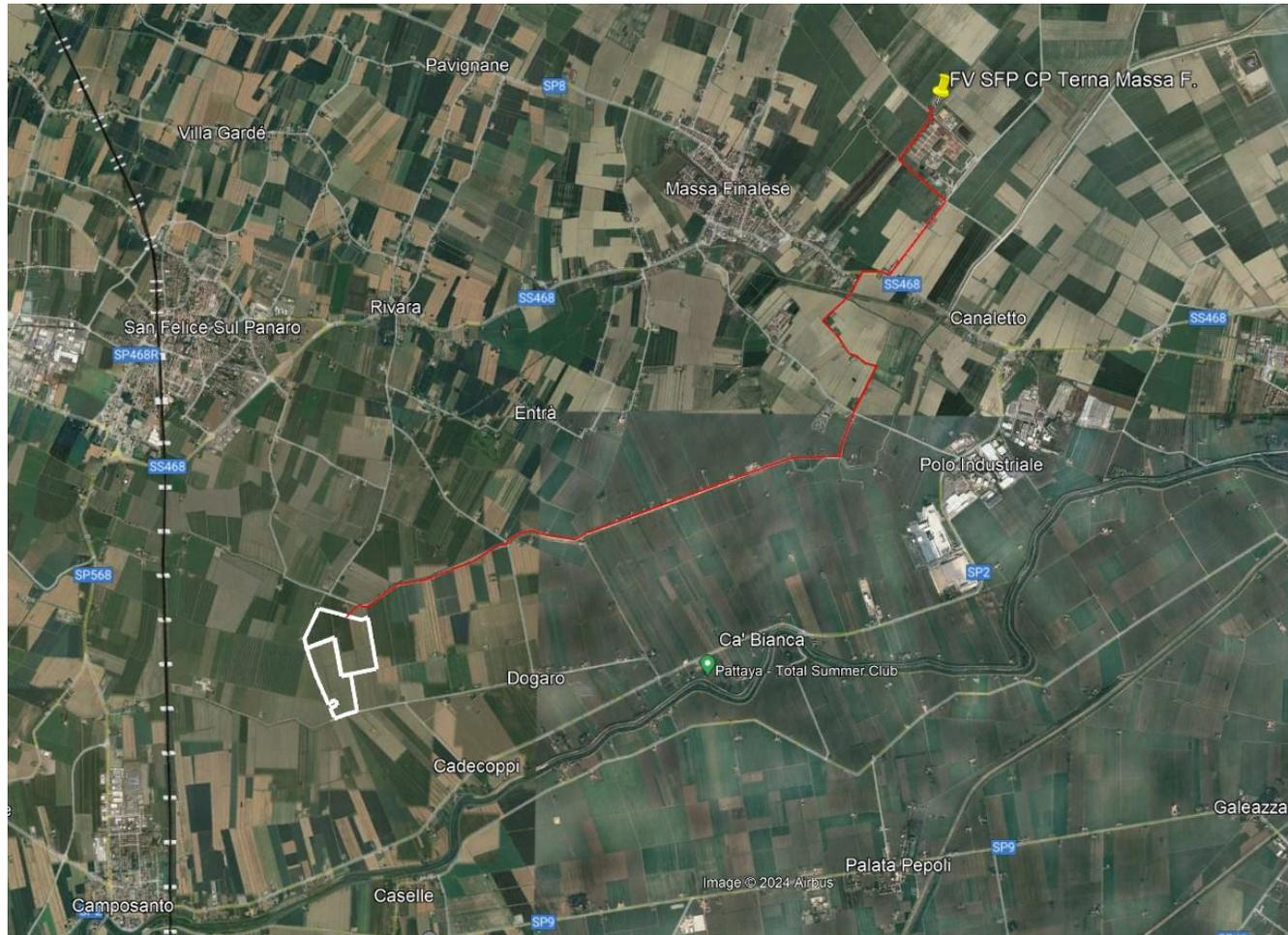
FIGURA 6: In bianco l'area dell'impianto agrivoltaico (circa 44 ettari) e in rosso l'elettrodotto di connessione alla RTN
