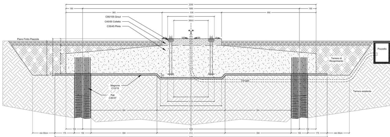
**Figura 7** – Dettaglio sezione fondazione
