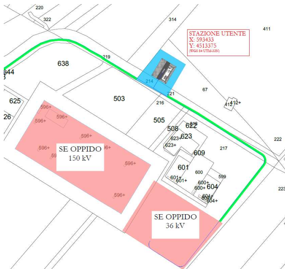
Figura 13 – Localizzazione della Stazione utente (2/2)
