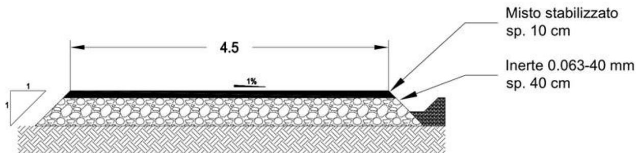
*Figura 2: sezione tipo*
