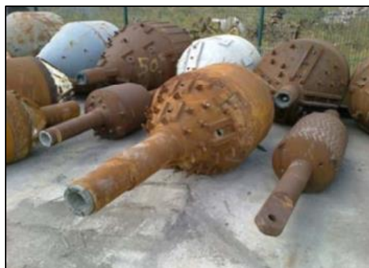
Figura 4-10 Esempi di punta di perforazione HDD e Reamer
