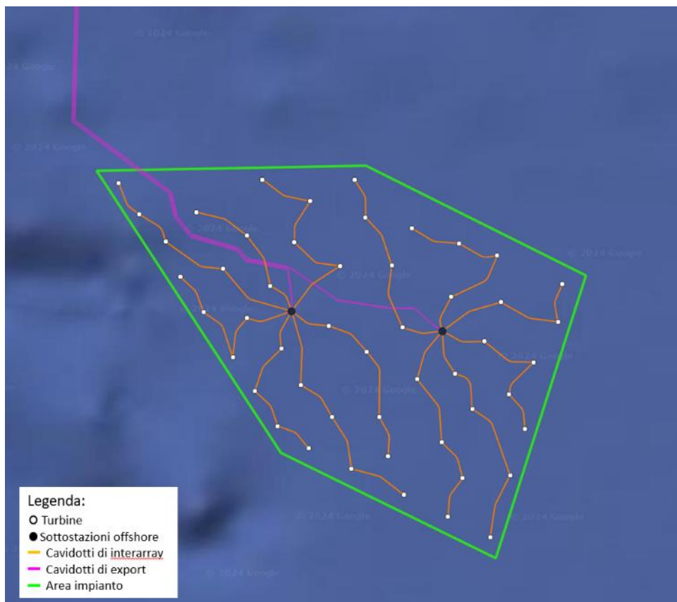
Figura 3-4 – Distribuzione dei cavi di collegamento tra gli aerogeneratori e le Stazioni elettriche offshore
