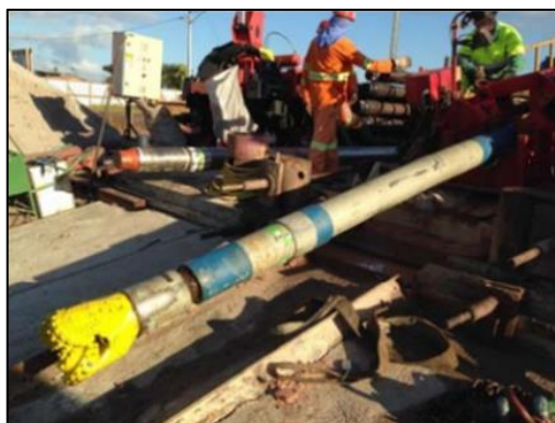
Figura 4-10 Esempi di punta di perforazione HDD e Reamer
