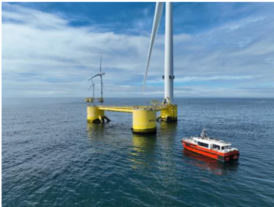
Figura 7-2 – Esempio di trasferimento del personale verso la struttura di fondazione con CTV (Kinkardine)
