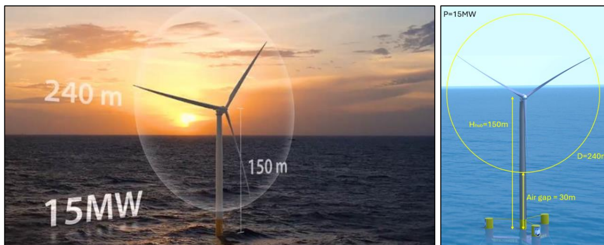
Figura 4-1 – Caratteristiche della IEA Wind 15-Megawatt utilizzata nell'analisi
