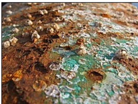
Figura 9 – Corrosione derivante da biofouling
