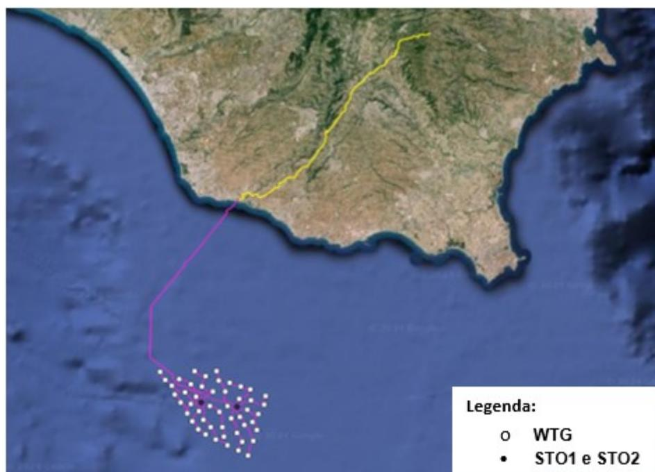
Figura 7-1 – Ubicazione delle turbine del Campo Eolico “Scicli” e delle stazioni di trasformazione offshore. La minima distanza da costa è 27 km.
