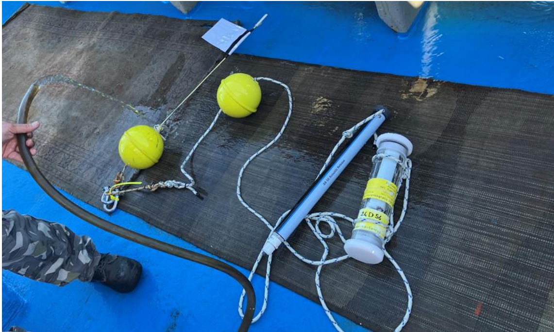
Figura 19: Un bottom recorder sul ponte subito dopo il recupero. Da sx a dx: galleggianti con bandierina, acoustic release e registratore.
