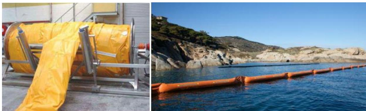
Figura 9-1 – Panne di contenimento auto-gonfiabili in dotazione dell'impianto per operazioni di prima risposta
