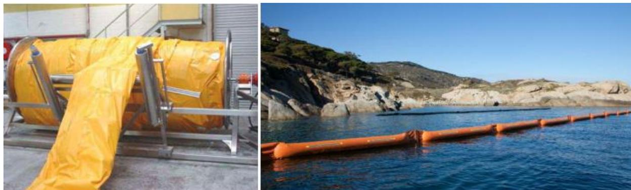
Figura 6-1 – Panne di contenimento auto-gonfiabili in dotazione dell'impianto per operazioni di prima risposta
