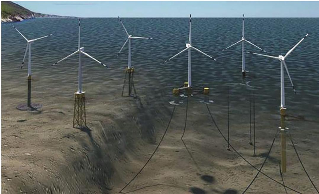
Figura 4.3: Tipologie di fondazioni utilizzate in ragione della profondità e delle caratteristiche dei fondali
