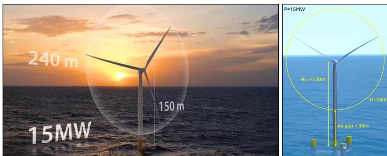
Figura 3-4: Aerogeneratore IEA Wind 15-Megawatt
