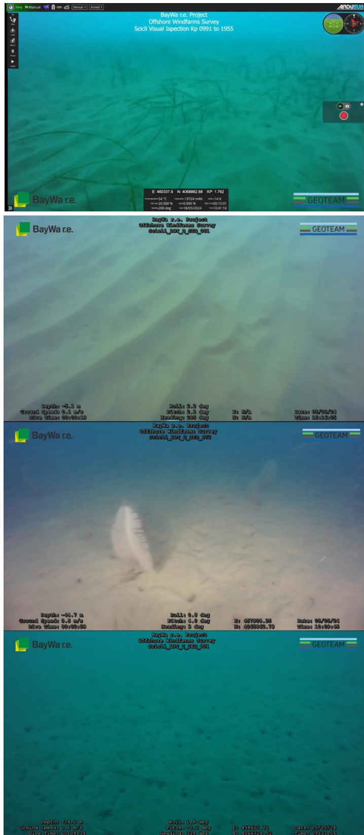
Figura 3-2: Immagini tratte dai filmati delle ispezioni ROV, rappresentative del fondale in diversi punti del tracciato previsto per il cavidotto marino
