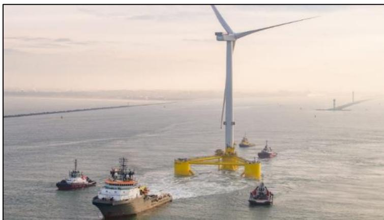
Figura 3-51: Esempio di trasporto a mare degli aerogeneratori (Coos Bay Offshore Wind Port Infrastructure Study - February 2022 – TotalEnergies SBE US)
