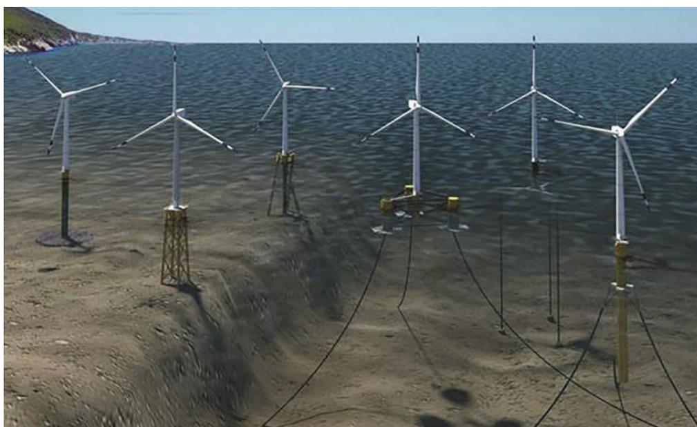
Figura 3-6: Tipologie di fondazioni utilizzate in ragione della profondità e delle caratteristiche dei fondali
