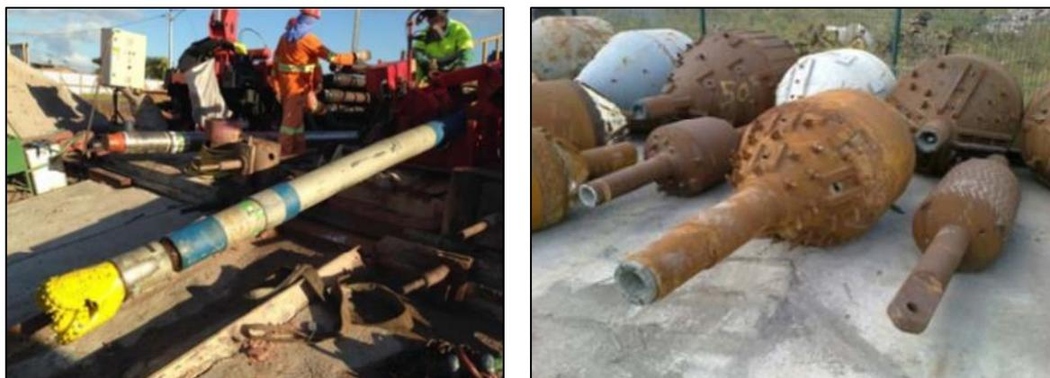
Figura 3-36: Esempi di punta di perforazione TOC e Reamer
