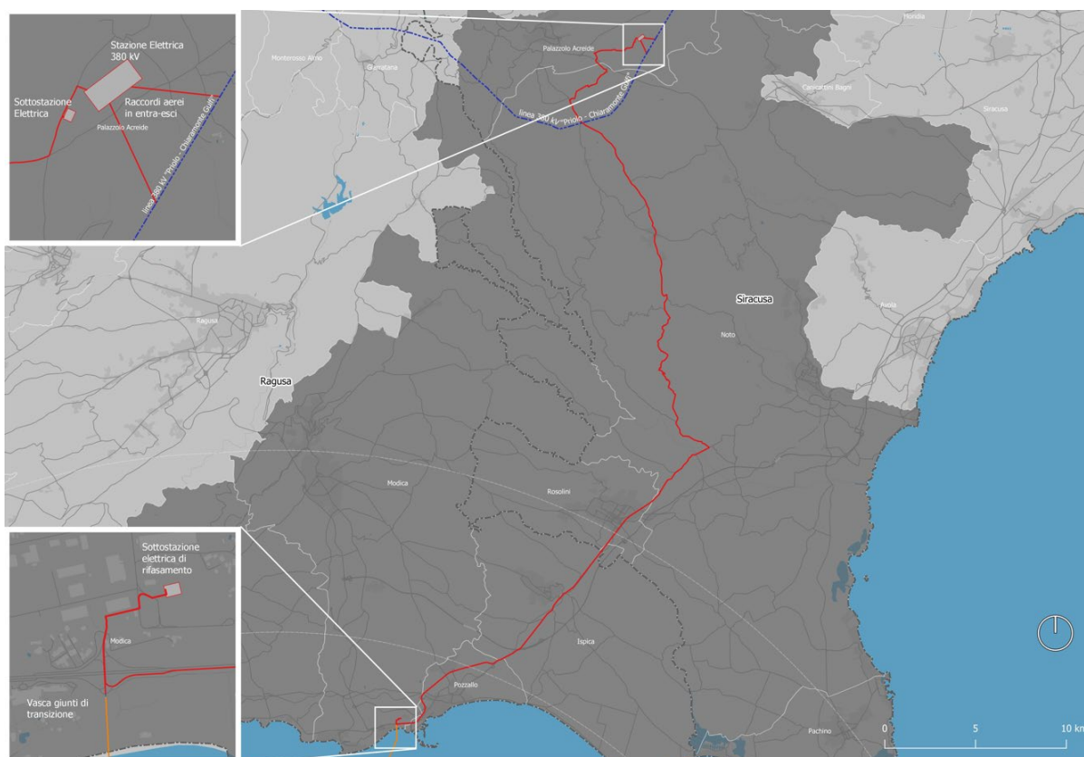
Il cavidotto interrato in progetto inquadramento generale
