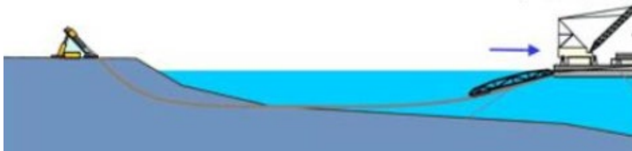
Realizzazione dell'approdo mediante tecnica TOC
