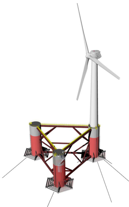
Figura 17: configurazione semisommergibile WindFloat da 2 MW [14] - la configurazione semisommergibile da 15 MW proposta in questo rapporto si basa su questa e su simili di dimensioni maggiori (vedi sezione 6.2.1)
