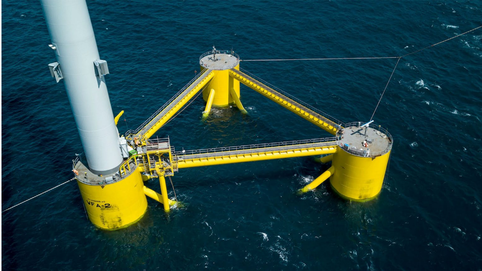
Figura 12: unità WindFloat T durante il traino. Da https://www.principlepower.com/windfloat/the-windfloat-advantage , consultato il 4 dicembre 2023. Per gentile concessione di Principle Power
