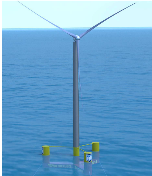
Figura 1: L'aerogeneratore offshore di riferimento IEA Wind 15-MW (si noti che, per il presente lavoro, sono state considerate solo le caratteristiche della torre e del gruppo rotore-navoletta – non della sottostruttura) [1]
