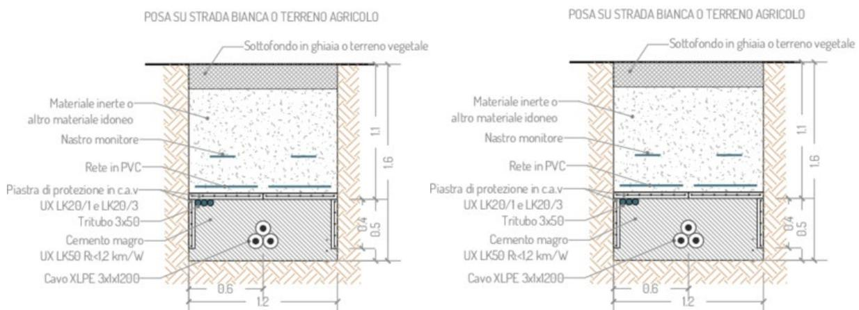
*Schemi tipologici di posa cavidotto*
