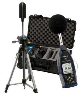
Il microfono utilizzato deve essere del tipo da esterni a campo libero. Qualora la sorgente non sia localizzabile o si sia in presenza di più sorgenti deve essere adottato un microfono da esterni ad incidenza casuale. Il microfono deve essere dotato di schermo antivento.
