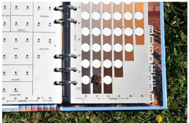
Figura 3-34 – A sinistra dettaglio della struttura dell'orizzonte A. a destra stima del colore con le tavole Munsell
