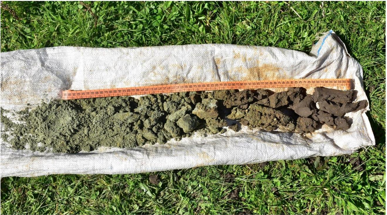
Figura 3-2 – Trivellata effettuata da 34cm a 90cm
