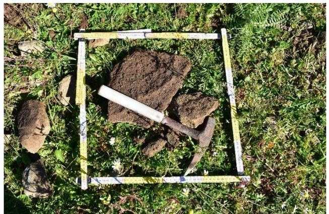
Figura 3-26 – A sinistra test della tessitura manuale, A destra dettaglio dello scheletro rilevato nell'orizzonte
