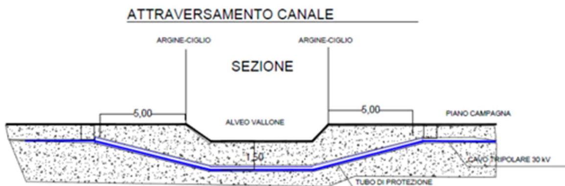
Tavola n.9: sezione tipo attraversamento canali con tecnica dello "spingi tubo" (TOC).
