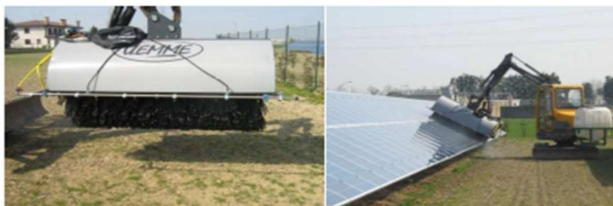
**Dispositivo di pulizia moduli Fig.3.27- Pulizia dei moduli**
