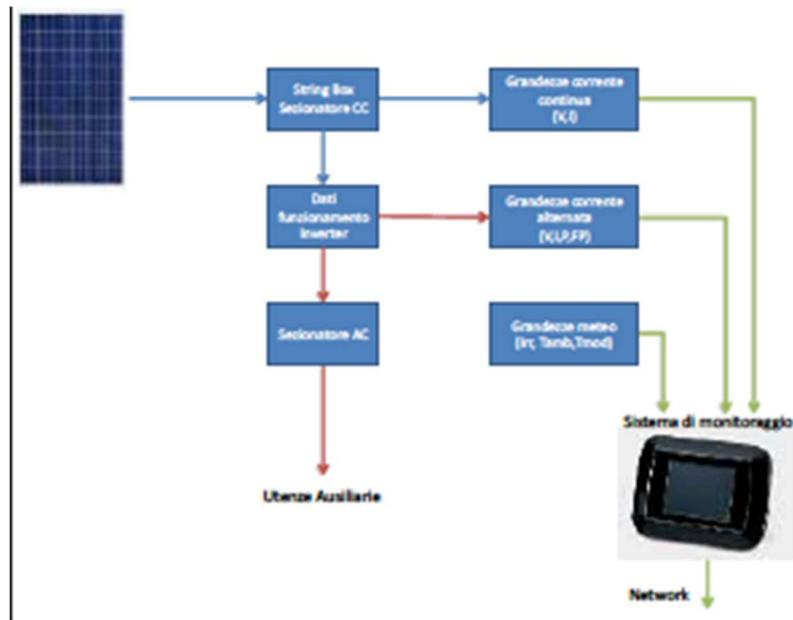
Lo schema riportato nella figura mostra l'architettura-tipo di un sistema di monitoraggio per impianti FV, evidenziando il tipo e i punti di prelievo delle grandezze misurate dal sistema.
