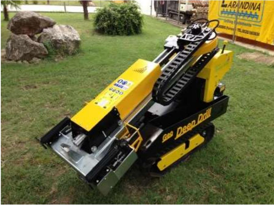
La resistenza opposta dal terreno alla punta conica viene correlata alle caratteristiche fisico-meccaniche e portanti del terreno, consentendo inoltre di riconoscere, con buona approssimazione, la stratigrafia del sottosuolo; il tutto fino alla profondità a cui la resistenza del terreno è tale da non permetterne più l'infissione (rigetto della punta).
