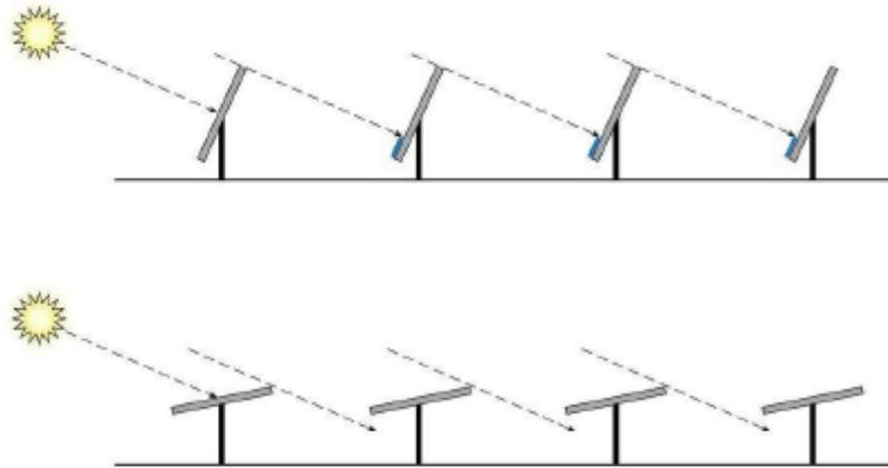
Il backtracking ruota l'apertura della matrice allontanandola dal Sole, eliminando gli effetti deleteri dell'auto-ombreggiatura e massimizzare il rapporto di copertura del suolo. Grazie a questa caratteristica l'interasse tra i vari le stringhe possono essere ridotte. Pertanto, l'intero impianto agrovoltaico occupa meno terreno rispetto a quelli che utilizzano soluzioni di tracciamento simili.
