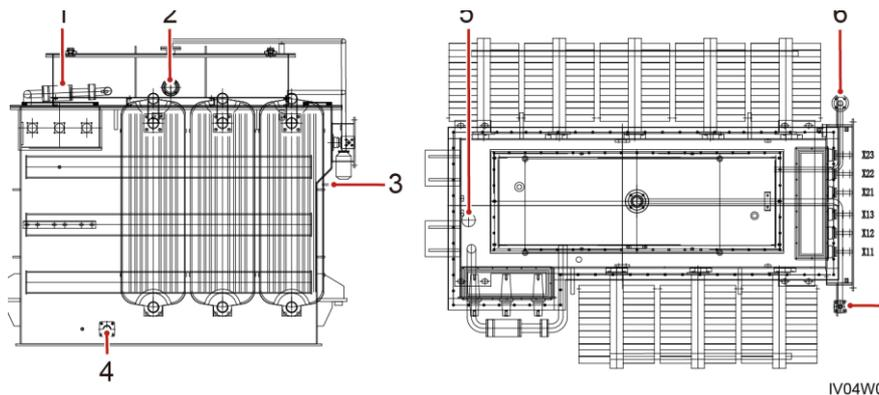
I trasformatori saranno costruiti in base alle norme IEC 60076-13 (o anche altri standard se richiesto) e caratterizzati da un livello di efficienza definito dalla norma Ecodesign, norme EN 50588-1, fase 1 e fase 2. Il nucleo è costituito da lamierino magnetico a cristalli orientati con basso livello di perdite e di rumore, gli avvolgimenti saranno realizzati di norma con conduttori in rame elettrolitico, ampi canali, assicurano una perfetta circolazione dell'olio nelle bobine.
