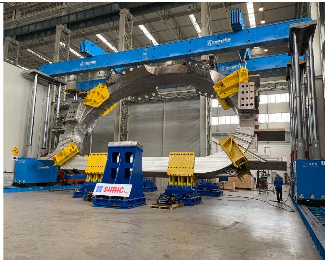
Gantry Crane in fase di movimentazione
