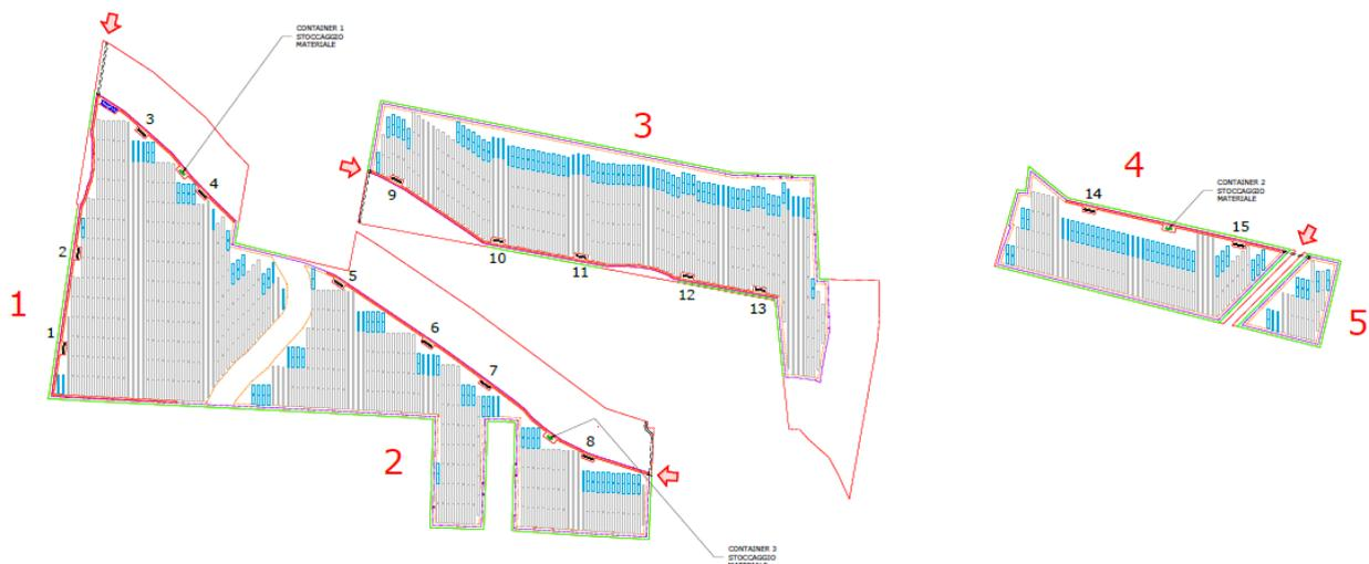
L'impianto sarà realizzato con 571 strutture (tracker) in configurazione 2x60 e 188 strutture (tracker) in configurazione 2x30 moduli in verticale con pitch=10,10 m. In totale saranno installati 79.800 moduli fotovoltaici monocristallini della potenza di 600 W.
