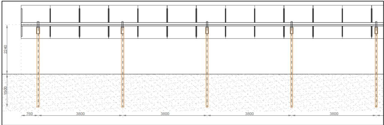
Figure 3: stralcio prospettico struttura di supporto 1x30P-30
