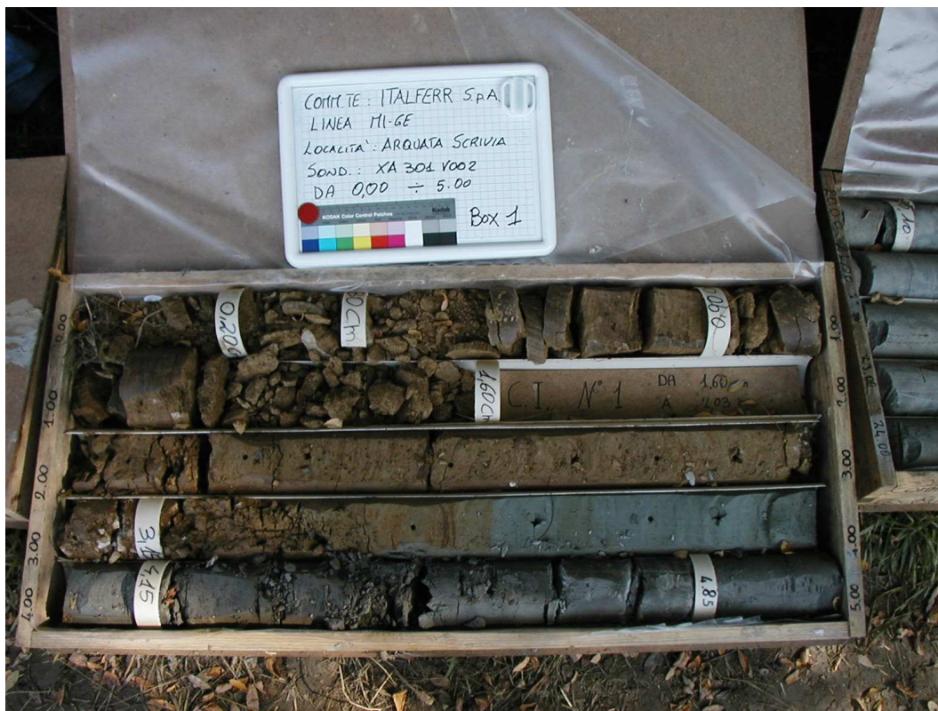
Figura 10 – Deposito alluvionale (limo sabbioso e ghiaia in matrice sabbioso/limosa) XA301V002
