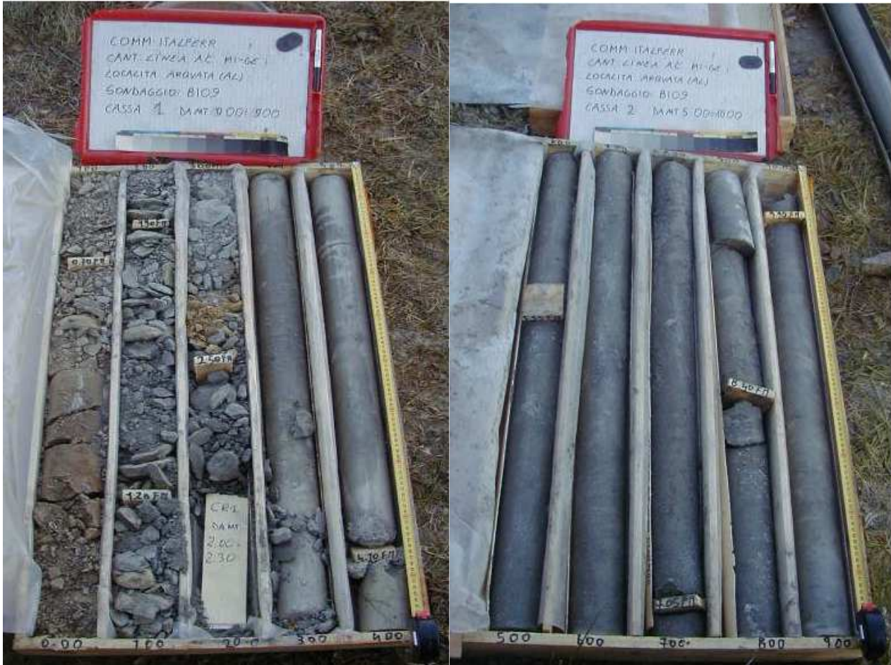
Figura 13 – Depositi alluvionali (ghiaia e limo) XA301V020
