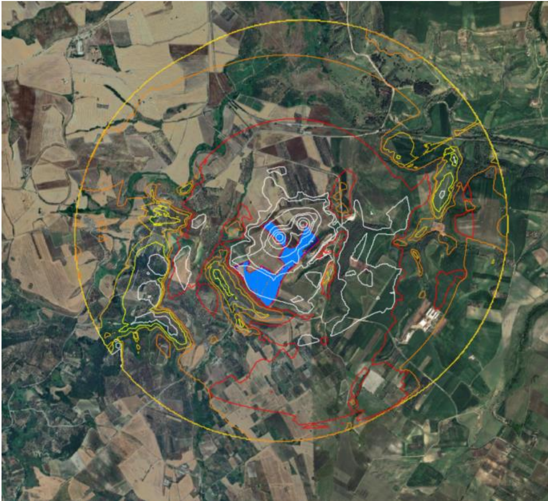
Figura 9 – Risultati della simulazione acustica di cantiere con linee di iso-rumosità con passo 5 dB dai 60 dB a 30 dB in bianco e poi dal rosso al giallo per l'intervallo 25 dB a 5 dB
