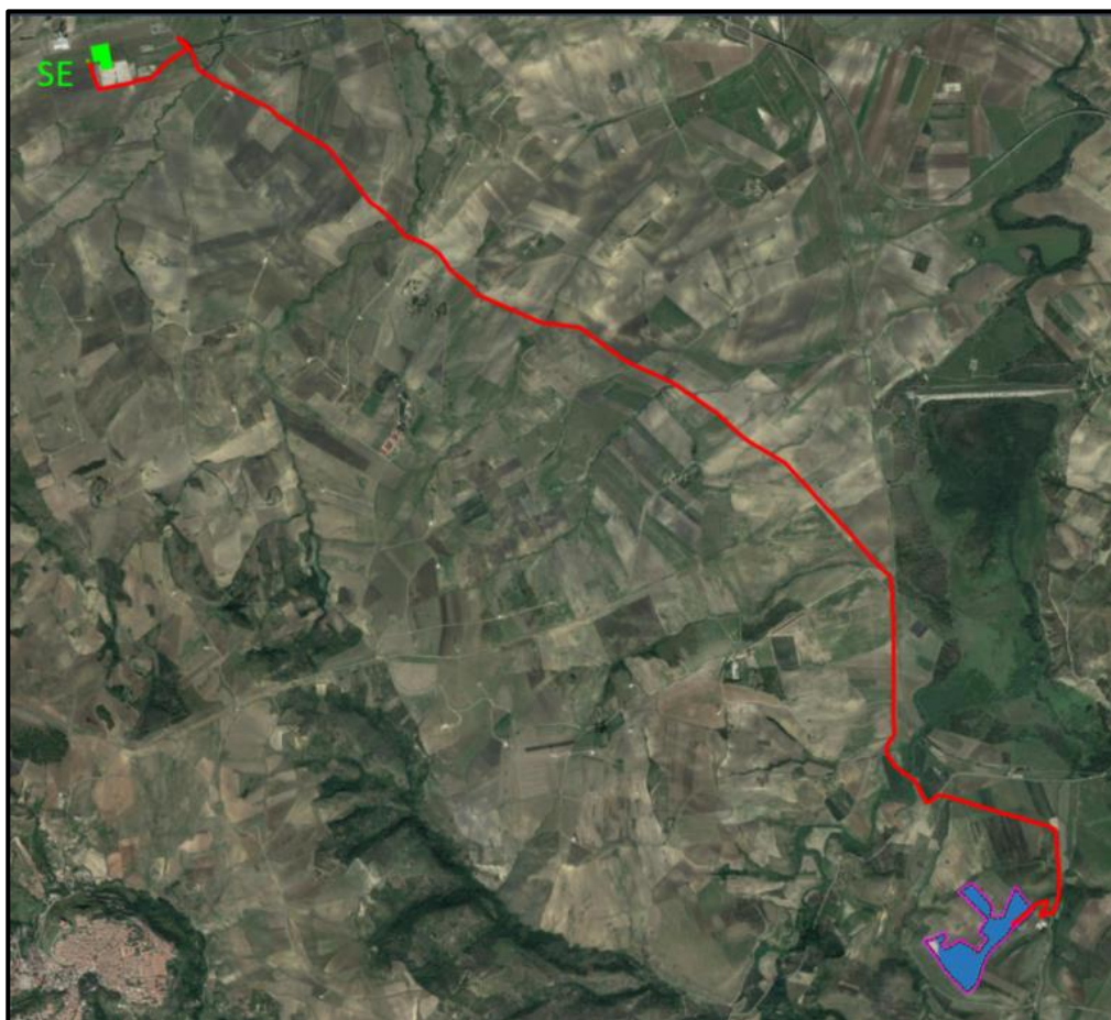
Figura 10 - Connessione alla RTN: confine catastale (in magenta), percorso del cavidotto (in rosso), futuro ampliamento della SE (in verde)
