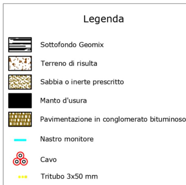
Figura 14 – Materiali di riempimento per scavo cavi esterni
