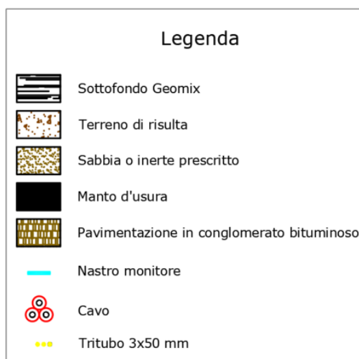
Figura 13 – Materiali di riempimento per scavo cavi esterni
