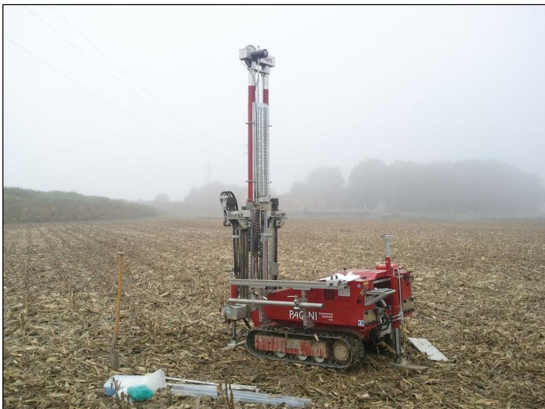
*Esempio esecuzione sondaggio a carotaggio continuo*
