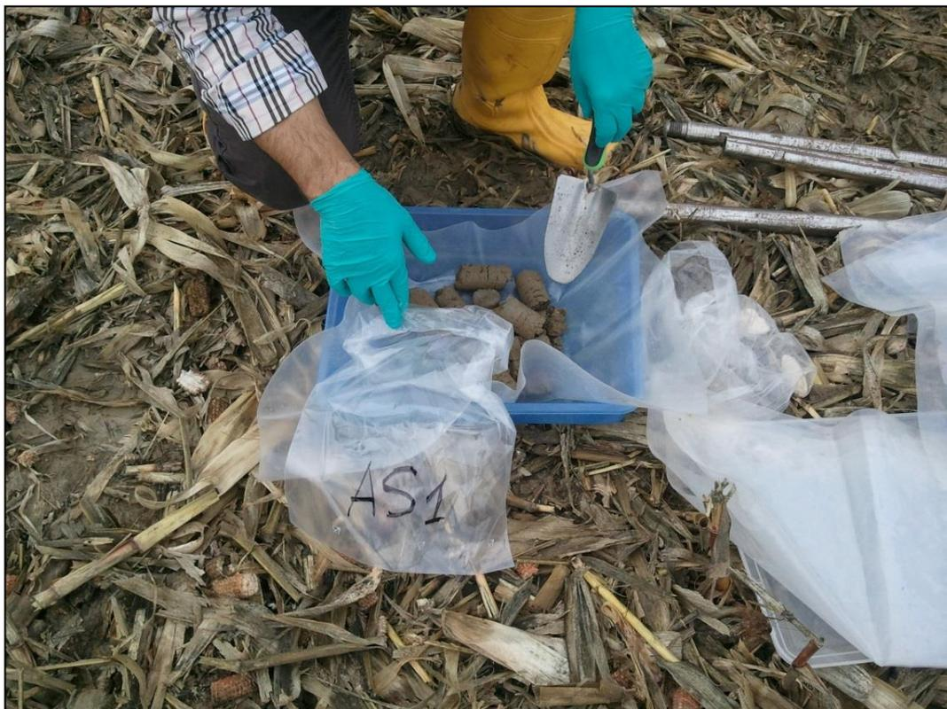
*Esempio miscelazione incrementi di terreno e preparazione campione per analisi*
