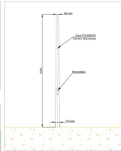
PARTICOLARE PALO E POZZETTO - Non in scala
