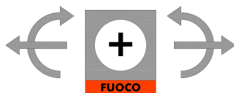
Figura 50 – convenzione di segno sollecitazioni derivanti dall'effetto del fuoco (coazioni)
