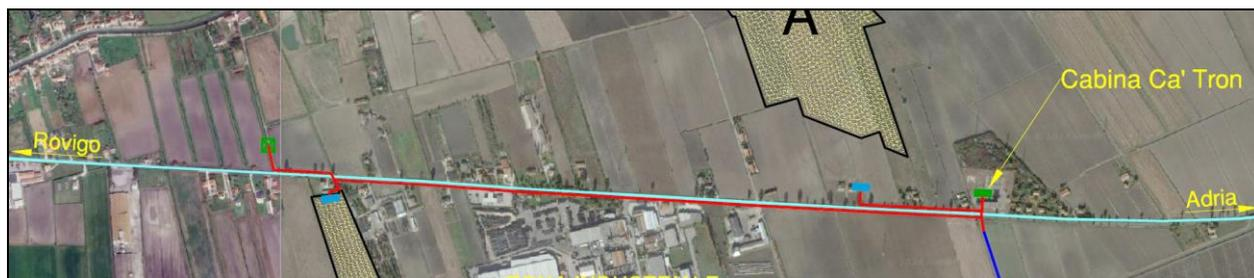
Figura 13: cavidotti interrati sulla S.R. 443
