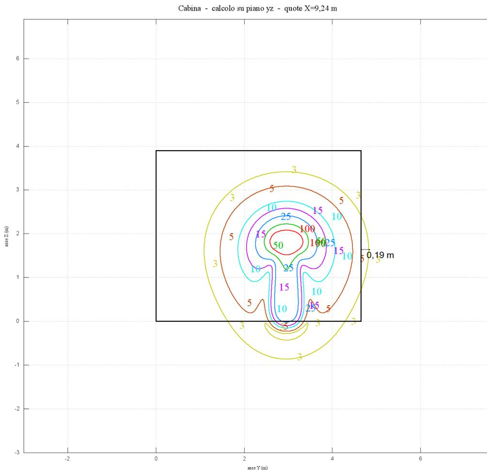
**11.2 Curve isolivello induzione magnetica nell'intorno della cabina di campo tipo.**
