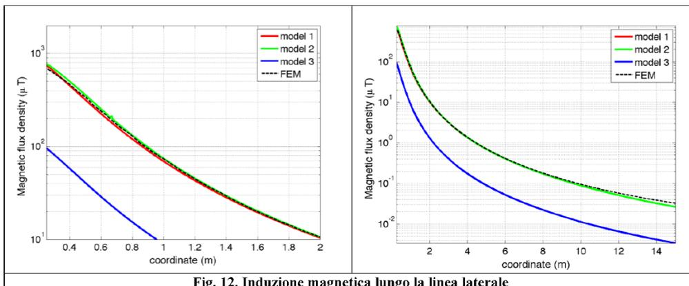
**Fig. 12. Induzione magnetica lungo la linea laterale**
