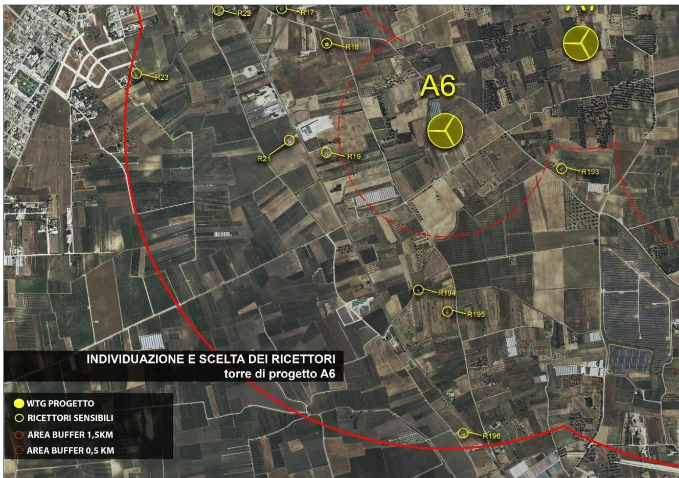
figura 20: Vista della porzione del parco di progetto con evidenza dell'aerogeneratore "A6" e dei ricettori indicati con etichetta "R". La linea in rosso indica il buffer di 1,5 km da ogni torre di progetto, così come previsto da normativa. La linea tratteggiata in rosso indica il buffer di 500 mt da ogni torre.
