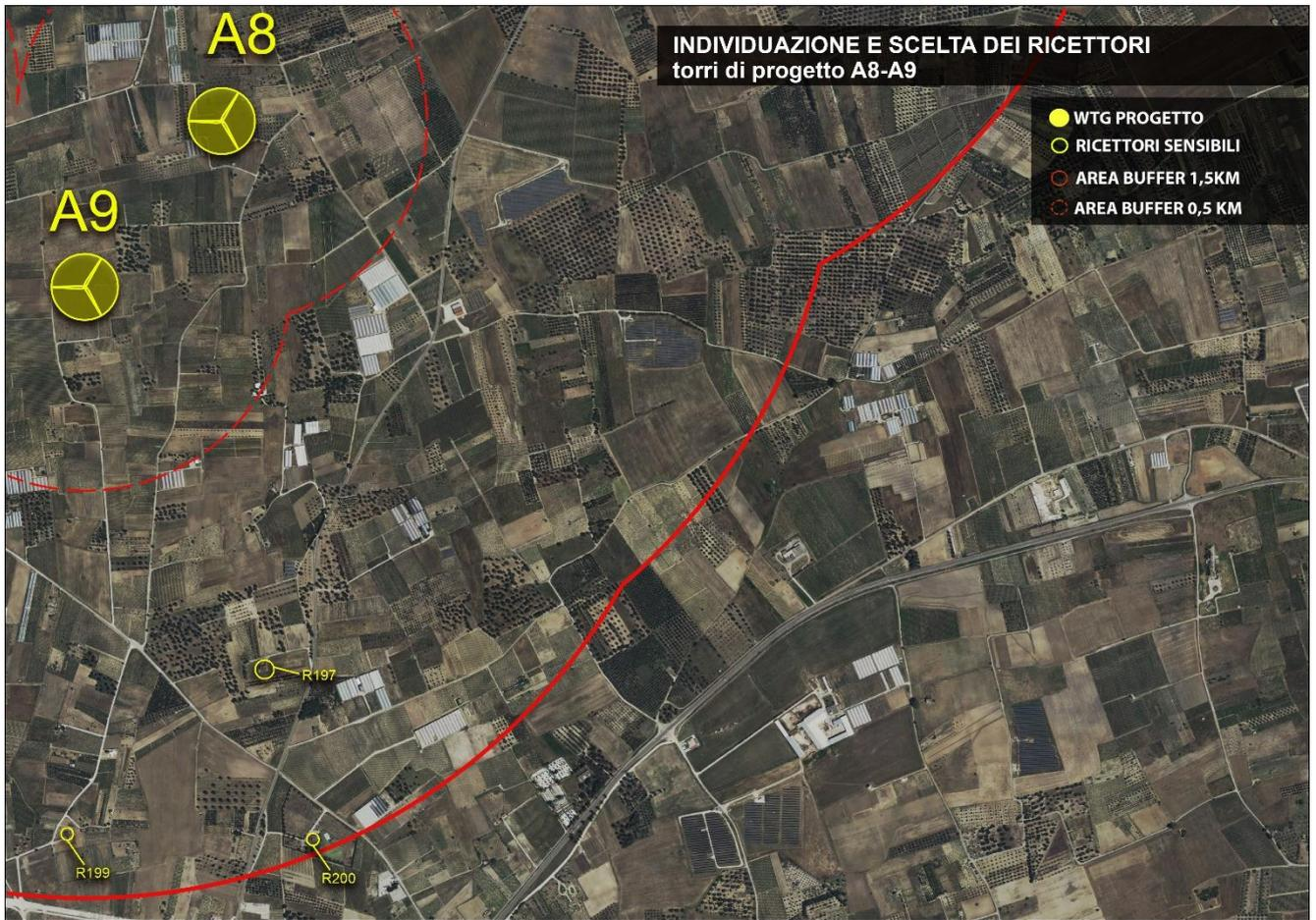
Figura 19: Vista della porzione del parco di progetto con evidenza degli aerogeneratori "A8 e A9" e dei ricettori indicati con etichetta "R". La linea in rosso indica il buffer di 1,5 km da ogni torre di progetto, così come previsto da normativa. La linea tratteggiata in rosso indica il buffer di 500 mt da ogni torre.
