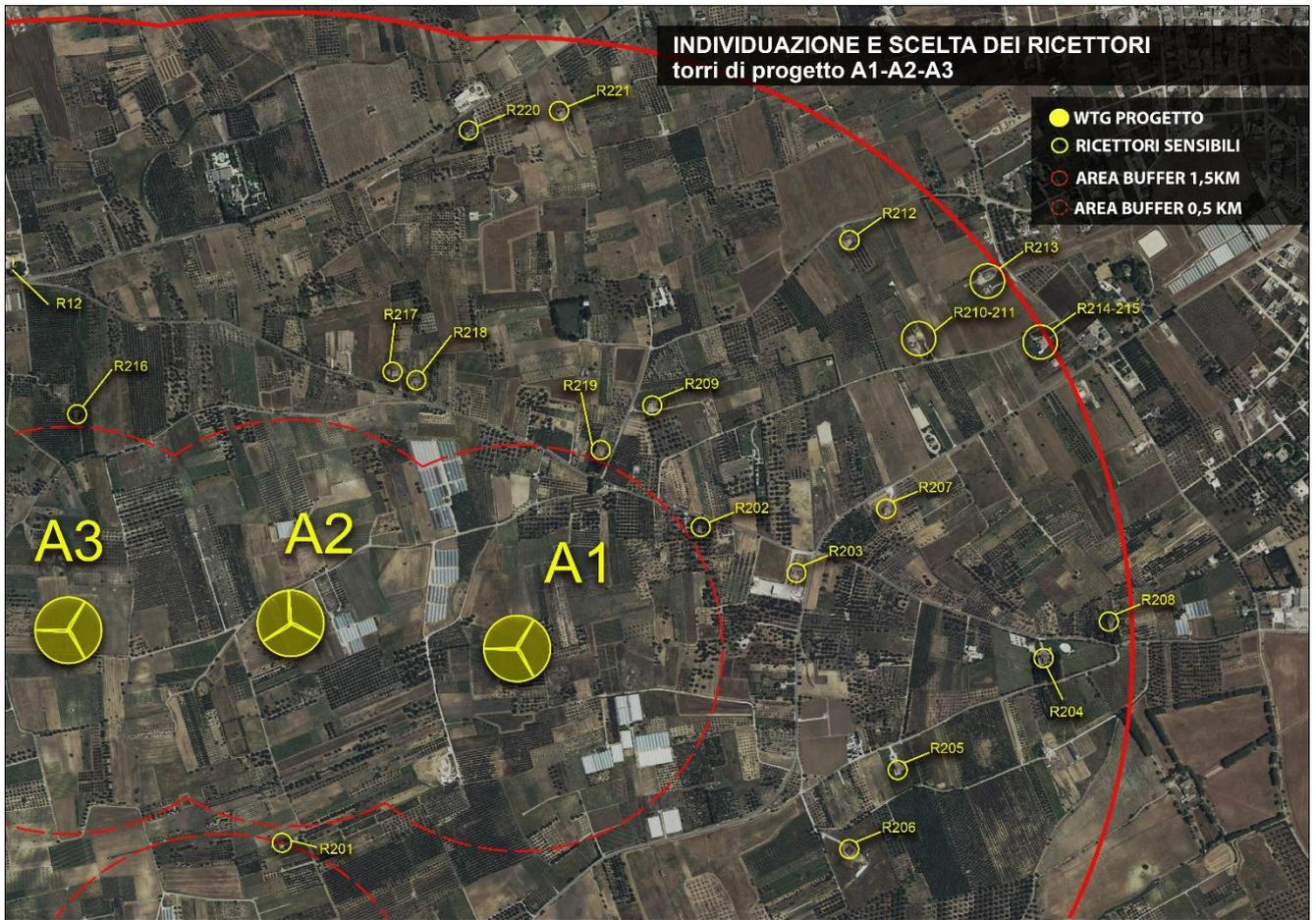
figura 18: Vista della porzione del parco di progetto con evidenza degli aerogeneratori "A1, A2 e A3" e dei ricettori indicati con etichetta "R". La linea in rosso indica il buffer di 1,5 km da ogni torre di progetto, così come previsto da normativa. La linea tratteggiata in rosso indica il buffer di 500 mt da ogni torre.
