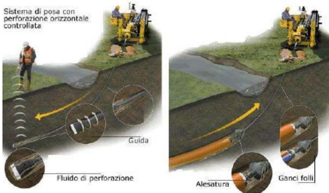
Posa in opera tubazione con trivellazione teleguidata
