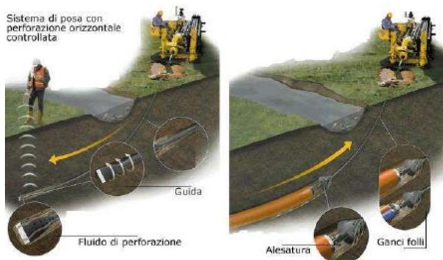
*Posa in opera tubazione con trivellazione teleguidata*
