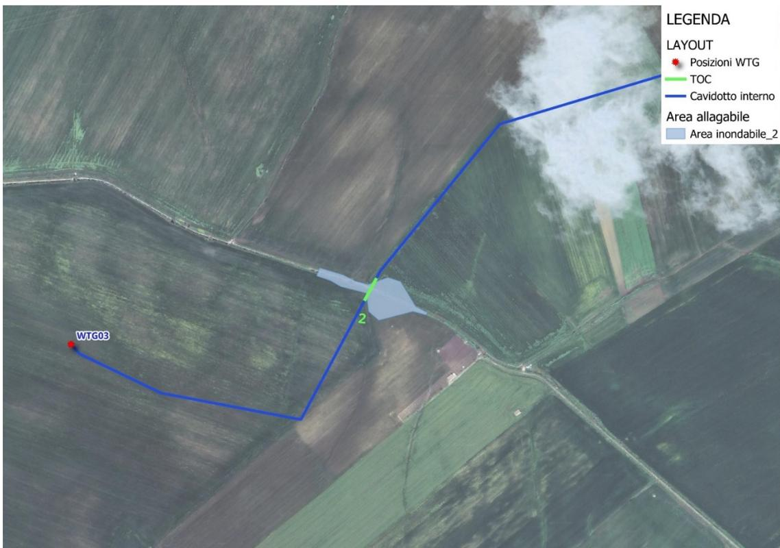
Area inondabile e indicazione del tratto di cavidotto da realizzare con T.O.C. (interferenza n.2)
