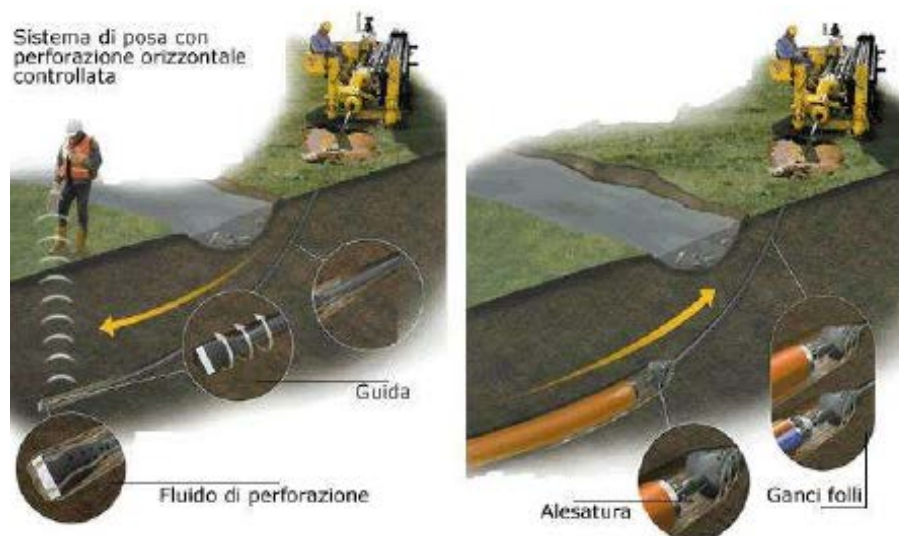
Posa in opera tubazione con trivellazione teleguidata
