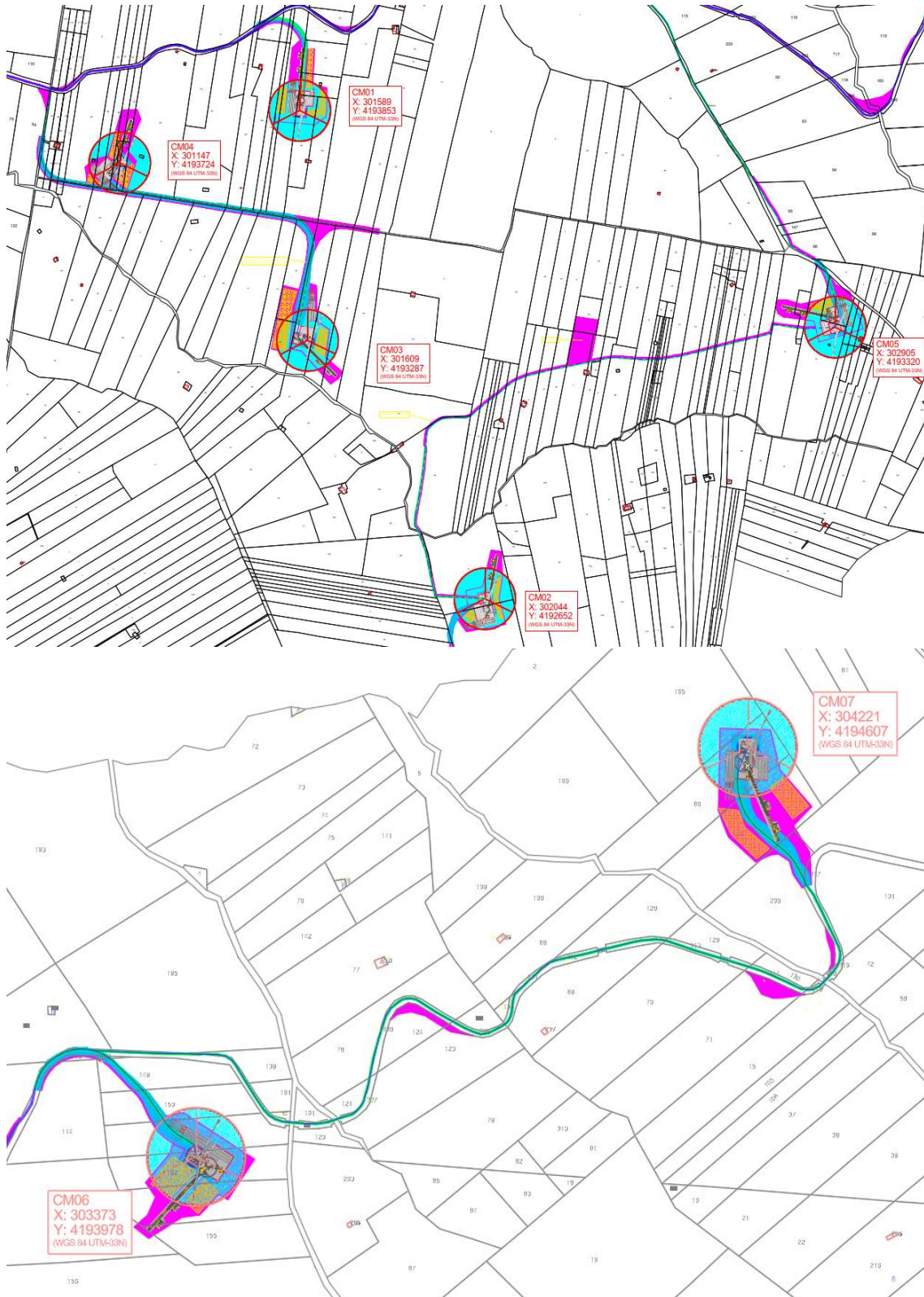
Fig. 5 viabilità di cantiere
