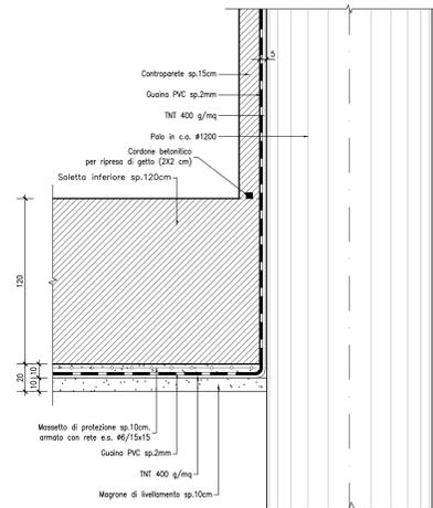
GIUNTO IN COPERTURA INTERRATA scala 1:5
