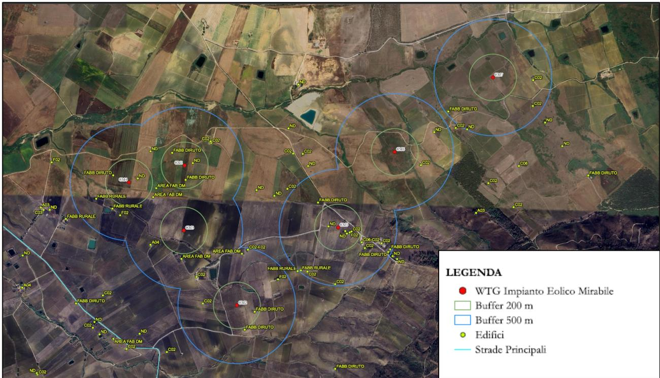
Figura 3: Ubicazione degli aerogeneratori rispetto alle strade ed agli edifici esistenti.
