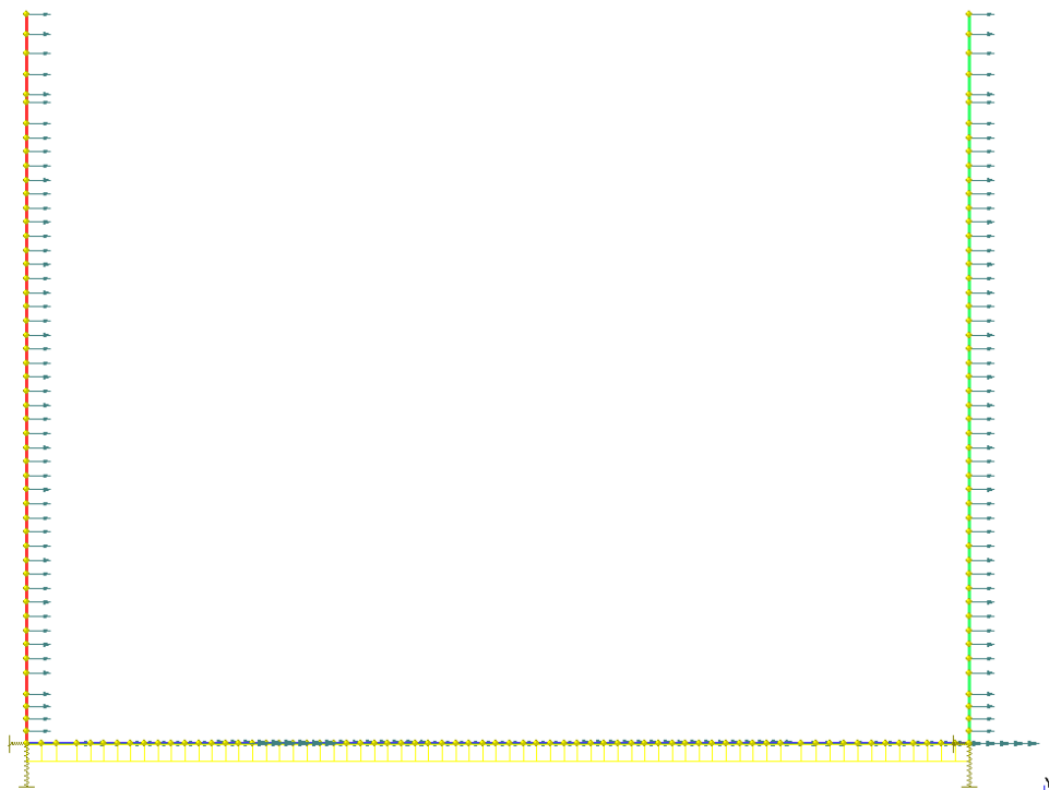
Figura 25 – Inerzia sismica orizzontale (Condizione 16)
