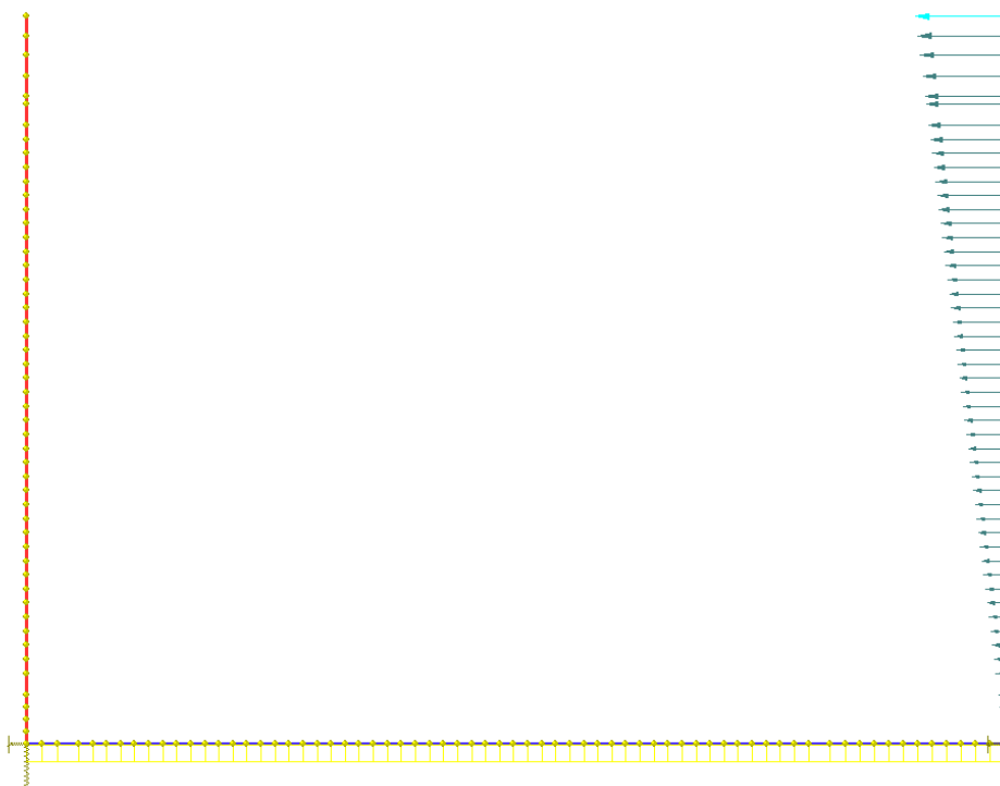
Figura 24 – Incremento spinta terreno sismica DX (Condizione 15)
